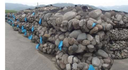
荒砥緊急資材倉庫 袋詰め玉石備蓄状況
