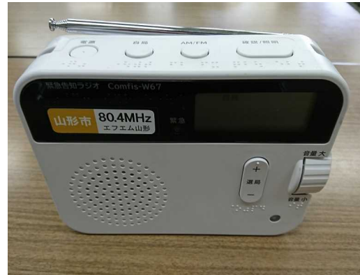
Comfis方式と呼ばれる自動起動システムを採用 (サイズ:幅17cm、高さ12.5cm、奥行き5.8cm)
