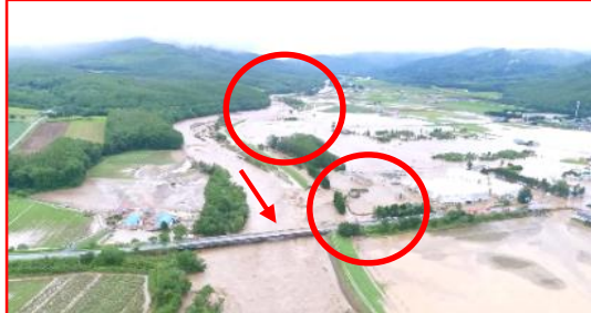
空知川の堤防決壊状況(南富良野町)
