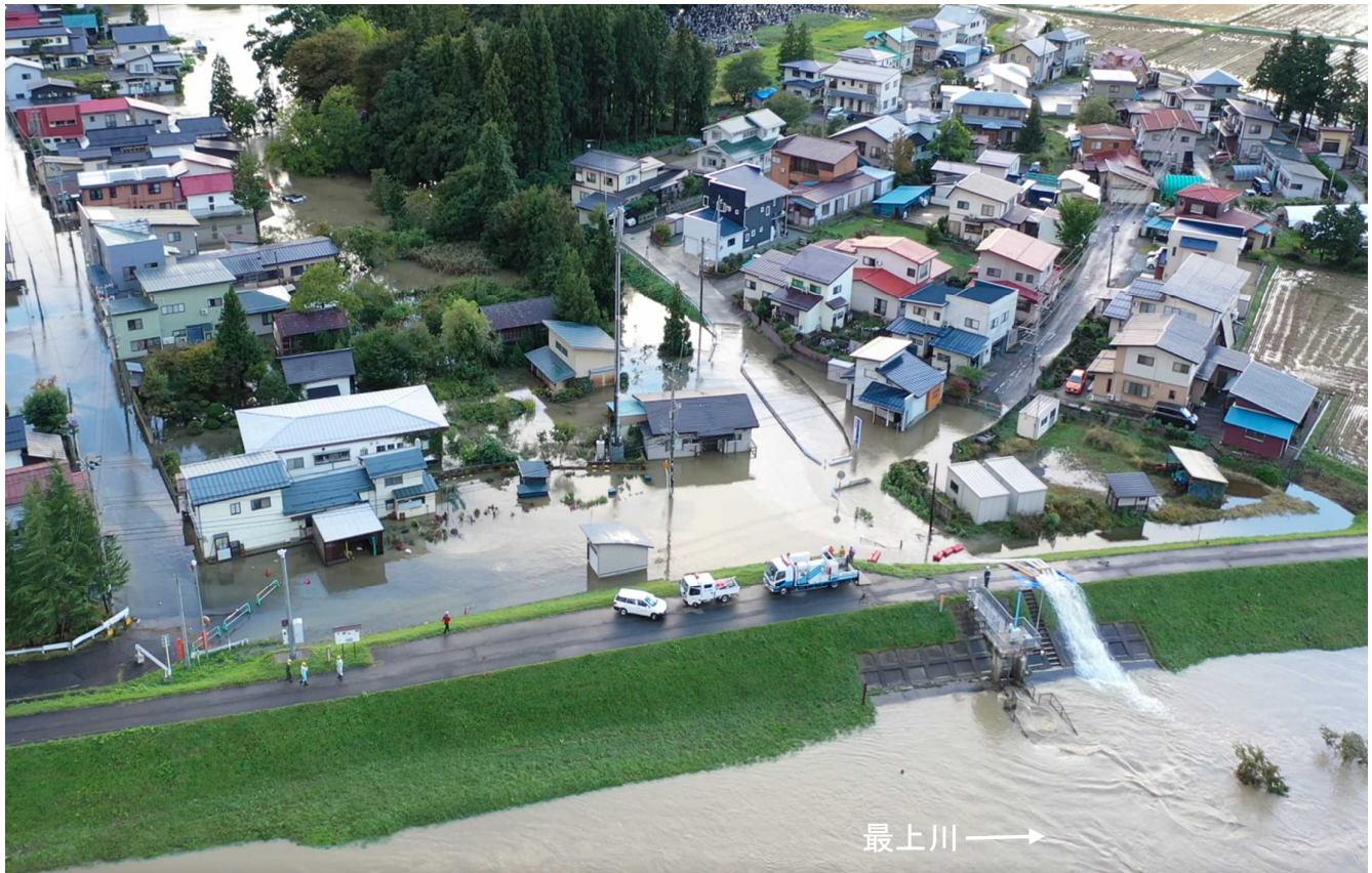
▲糠野目地内 排水ポンプ車稼働状況
