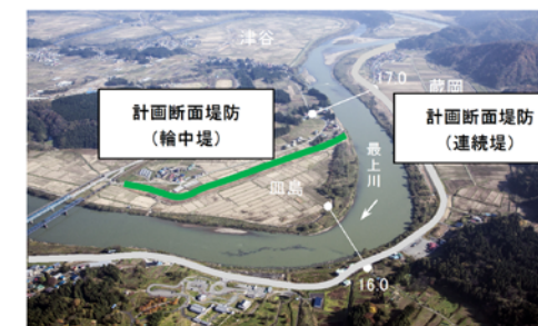
図 5-18 堤防整備イメージと整備箇所例
