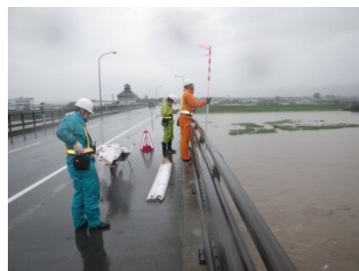
浮子による流量観測（洪水時）
