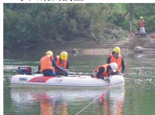
ボートによる流量観測（平水時）
