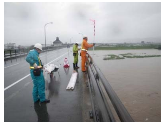
浮子による流量観測（洪水時）
