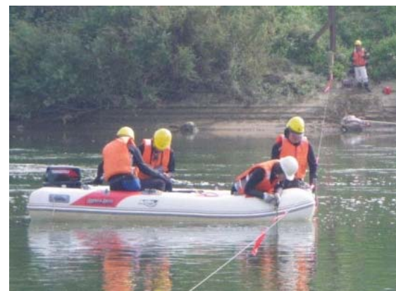
ボートによる流量観測（平水時）
