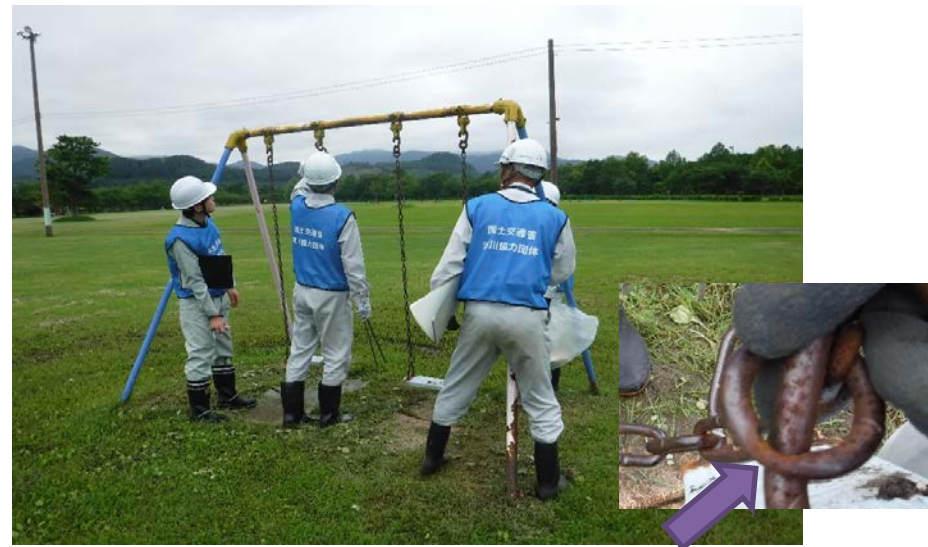
遊具(ブランコ)の点検を実施。チェーン部の摩耗を発見した。
