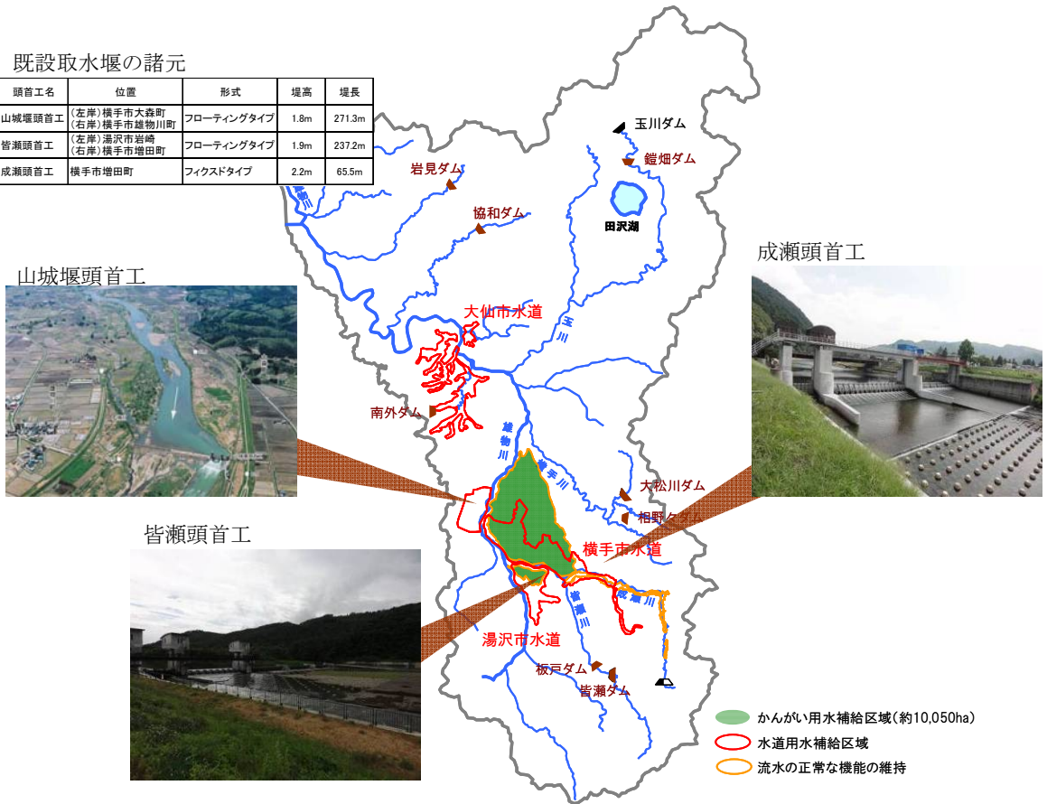
図 4.4-14 中流部における代表的な既設取水堰
