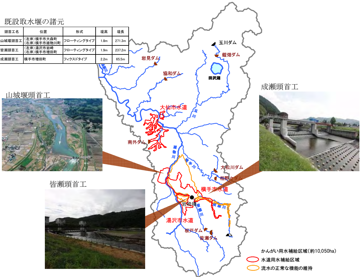
図 4.5-4 中流部における代表的な既設取水堰
