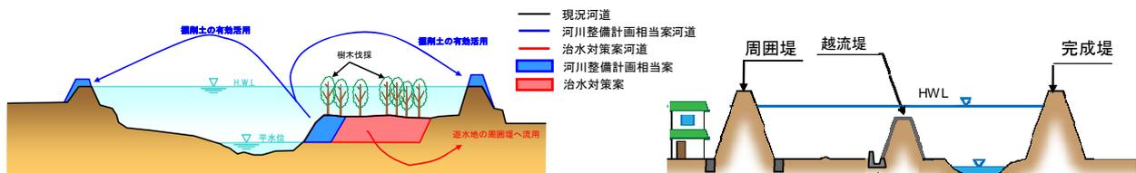
※中流部で現在堤防未施工の区間はHWLまで築堤する。
