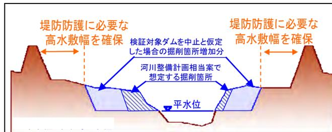
図 4.2-10 河道掘削のイメージ
