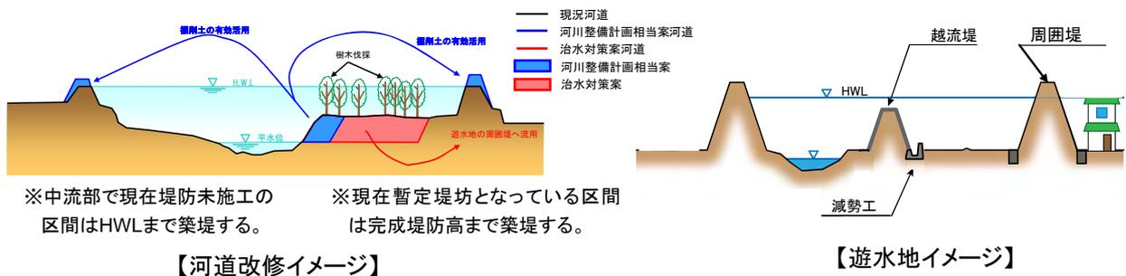
※中流部で現在堤防未施工の区間はHWLまで築堤する。
