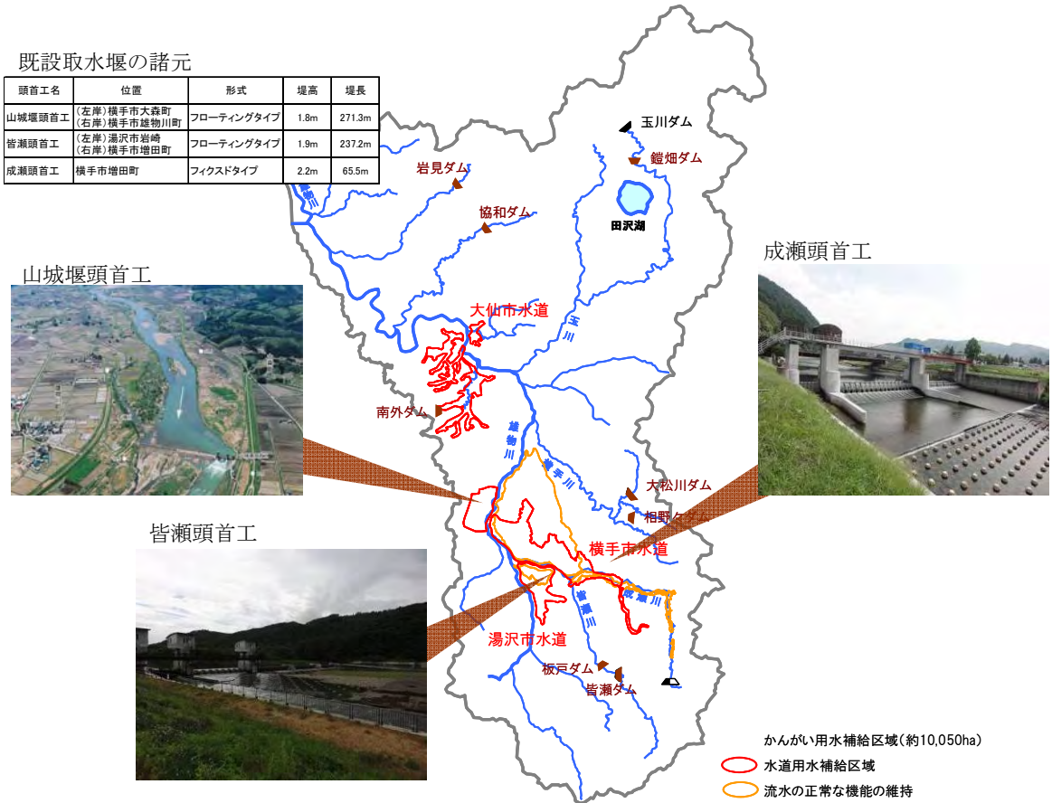
図 4.3-3 中流部における代表的な既設取水堰
