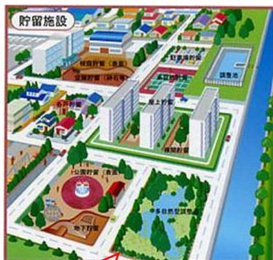
雨水調節地などを整備し、雨水を貯留する。
