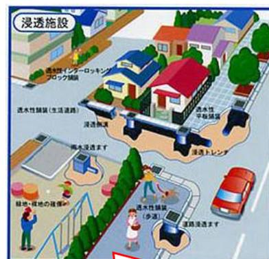
雨水浸透ますなどを整備し、雨水を浸透させる。
