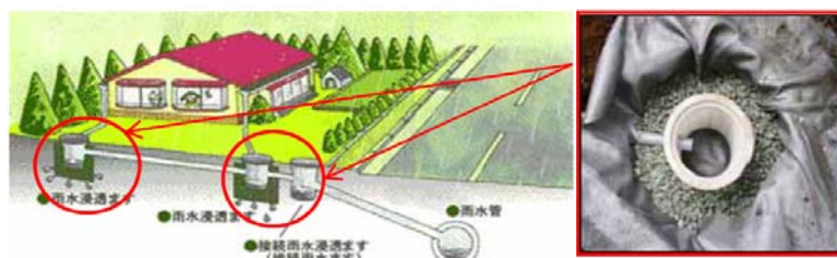
雨水浸透施設の例
