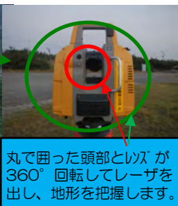
地上レーザ機器を使って測量中です
