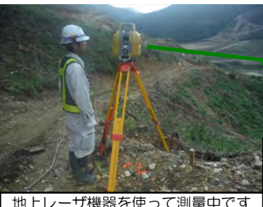
地上レーザ機器を使って測量中です
