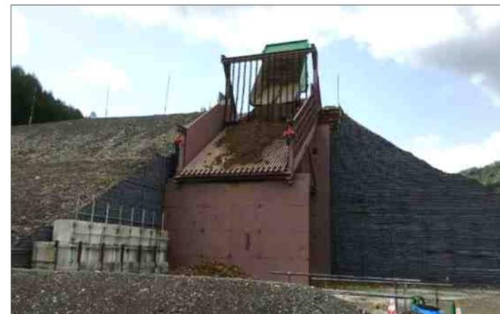
簡易ふるい設備 (バーから扁平材がすり抜ける)
