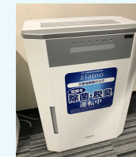
ジアイーノを4台設置 (パナソニック製 次亜塩素酸 空間除菌脱臭機)
