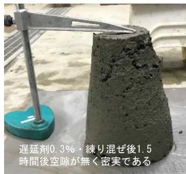
コンクリートスラブ試験（超遅延剤0.3%添加時の効果比較）
