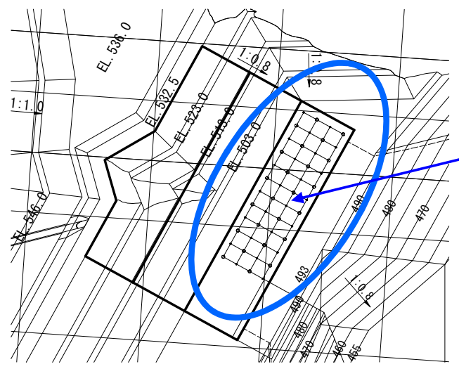
止水線より下流側全面(青範囲)L=576m
