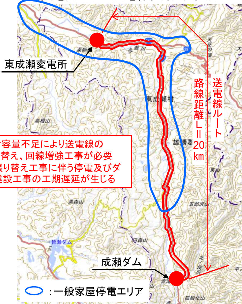
変電所からの送電線経路 位置図
