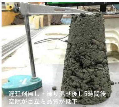
コンクリートスラブ試験（超遅延剤0.3%添加時の効果比較）
