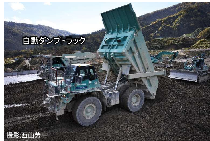
②CSG運搬（自動ダンプトラック） 自動ダンプトラックにより打設を行う場所までCSGを運搬します。
