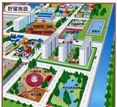
雨水調節地などを整備し、雨水を貯留する。
