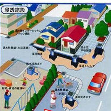
雨水浸透ますなどを整備し、雨水を浸透させる。
