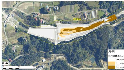
▲数値計算シミュレーションによる遊砂地内の土砂堆積予測(内川遊砂地)
