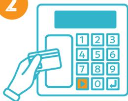
STARTボタンを押してから、専用ICカードを操作パネルにかざし、電子錠を解除します。
