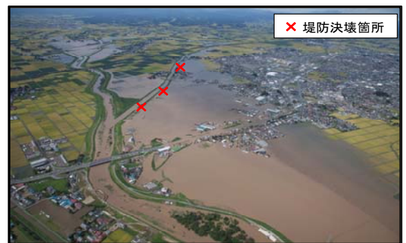
平成27年9月関東・東北豪雨で 3箇所堤防が決壊した渋井川
