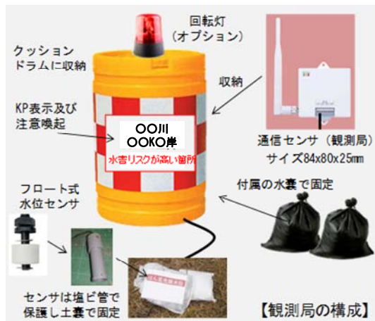
水害リスクが高い箇所を監視するための簡易アラート装置
