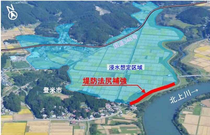
補正予算により、堤防法尻補強を実施し、越水による逃げ遅れの被害を軽減します。
