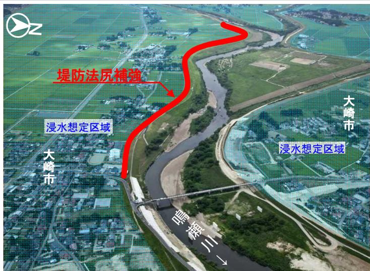
補正予算により、堤防法尻補強を実施し、越水による逃げ遅れの被害を軽減します。
