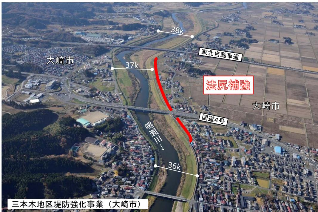
法尻補強を行い、越水による逃げ遅れの被害を軽減します。
