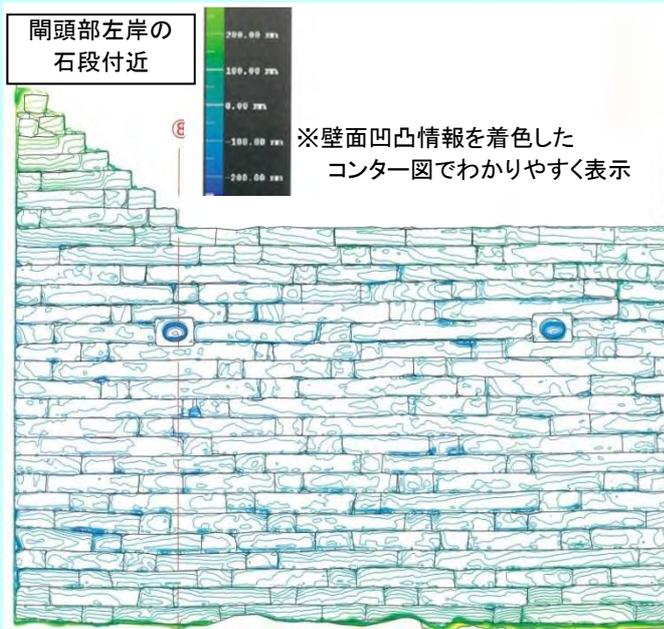
3Dレーザー測量成果の活用事例①(煉瓦積み壁面凹凸情報)
