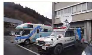
通信衛星車による通信回線の確保
