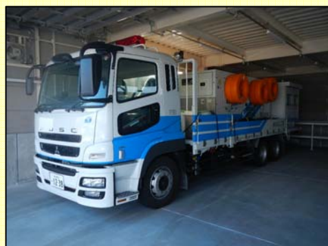
一関防災センターに配備されている排水ポンプ車。1分間に30m 3 の水を排除する能力があります。
