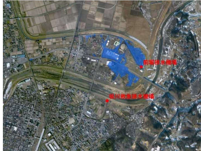
前堀排水機場による浸水抑制効果
