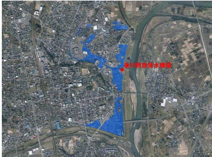
後川救急排水機場による浸水抑制効果
