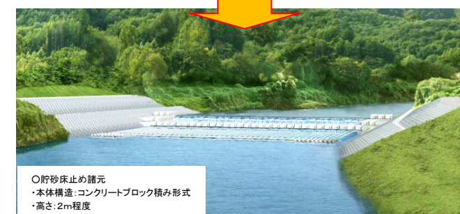
四十四田ダム 貯砂床止め完成予想図(洪水期)
