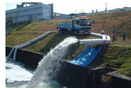
排水ポンプ車の操作訓練
