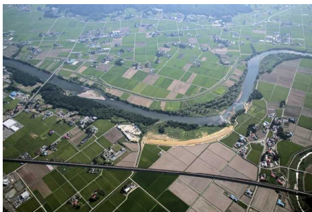
北上川中流部緊急治水対策事業の輪中堤整備状況 (紫波町甘木地区)
