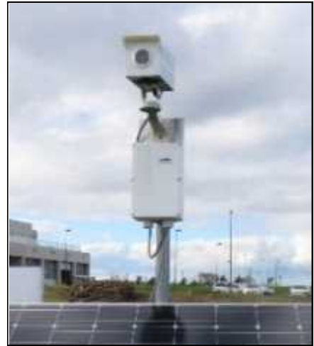
簡易型河川監視カメラ
