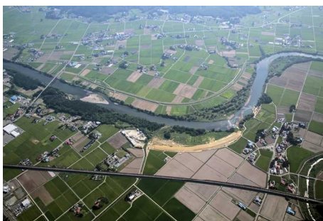
北上川中流部緊急治水対策事業の輪中堤整備状況
