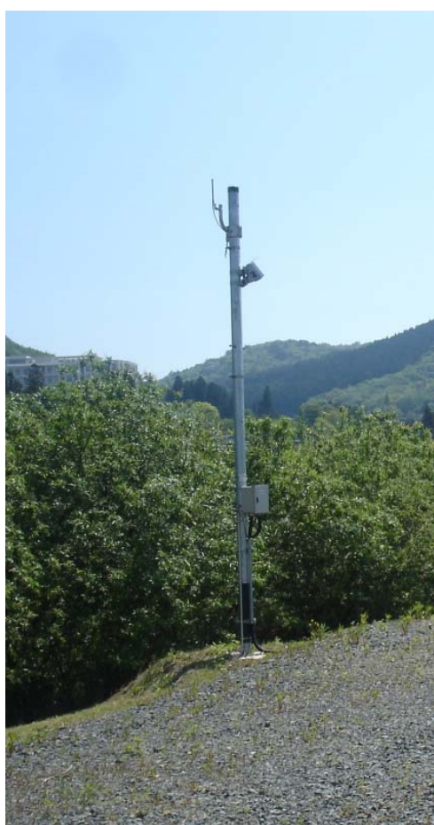
水害リスクが高い箇所でリアルタイムに水位を把握する簡易水位計
