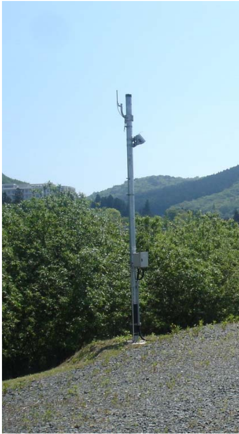
水害リスクが高い箇所で リアルタイムに水位を把握する簡易水位計
