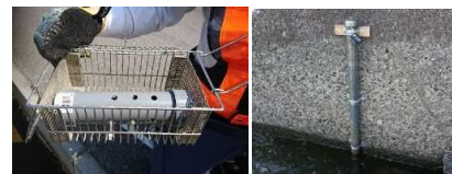
● 水位計の設置予定箇所
