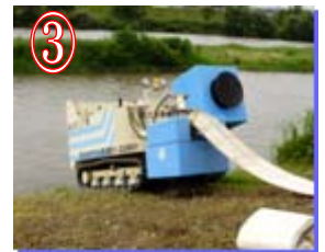
③伏黒出張所にあるクローラ式排水ポンプ車
