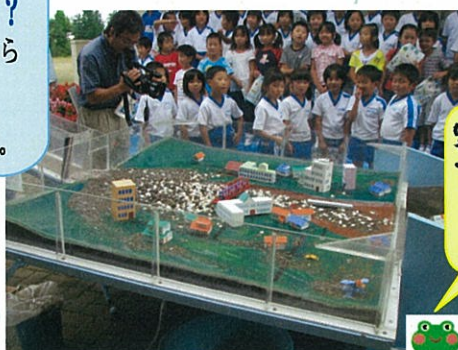
土石流の模型実験の様子
