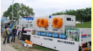
▲伏黒出張所からは排水ポンプ車が出動。
