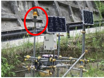
▲不動沢第2に設置しているセンサー 土石流が引っかけると手前の機械が倒れ、不動沢第4の警報器が鳴ります。 ▲不動沢第4に設置されている警報器 災害発生時、音とランプが点滅した際には作業員が高台に避難します。
