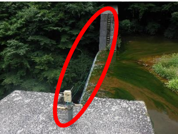
▲不動沢第2に設置しているセンサー 土石流が引っかけると手前の機械が倒れ、不動沢第4の警報器が鳴ります。 ▲不動沢第4に設置されている警報器 災害発生時、音とランプが点滅した際には作業員が高台に避難します。
