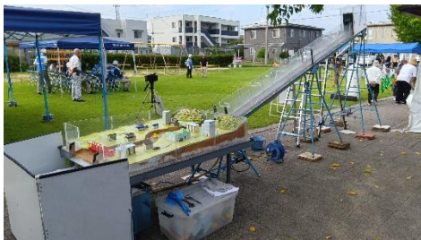
◀土石流模型実験の装置はとても大きいです。家の模型などを並べて、土砂災害が起きたときに砂防堰堤がどのような役割を果たすのかがよく分かる実験を行います。
