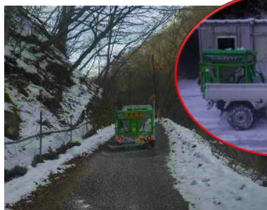
▲凍結防止剤散布機を搭載した軽トラックで朝一番で凍結防止剤を散布してから、作業車両が現場へ向かいます。
