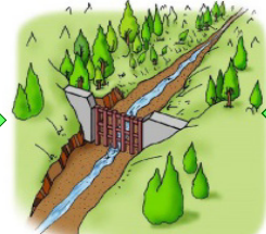
②透過型砂防堰堤を設けた場合でも、普段は、水と土砂は同じように下流に流れていきます。
