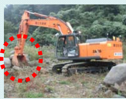
▲遠隔操作でも、土砂をしっかりと引き出します
