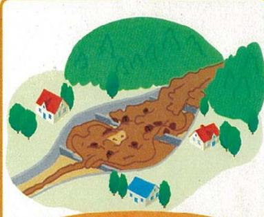
泥水を分散して威力を弱め岩や土砂を堆積させる。
