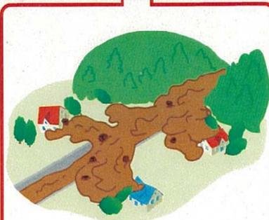
大きな岩を含む土砂が大量に流入すると流路内で堆積し、流下断面を確保できず氾濫する。
