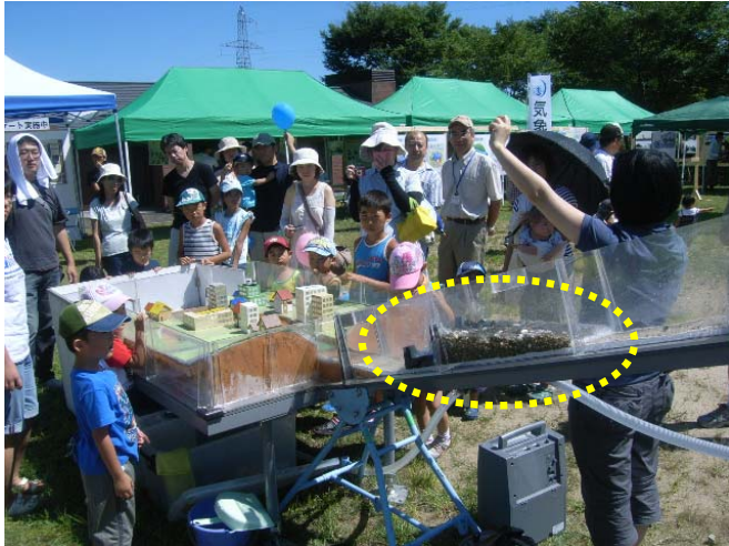
砂防堰堤が土砂をしっかりキャッチ！ たまった土砂は勢いを減じて下流に流れます。
