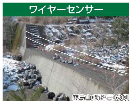
ワイヤーセンサー 霧島山(新燃岳)の例 土石流の発生を検知します。
