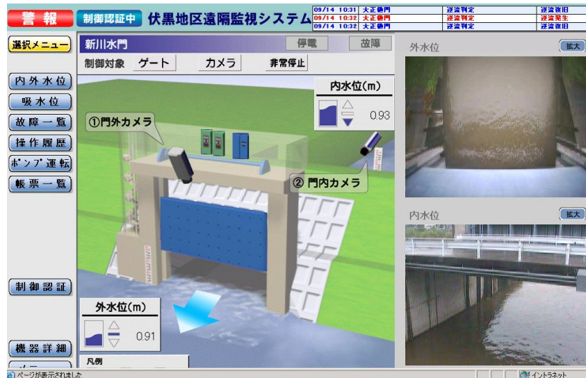
図 5-3 1 河川管理施設の遠隔監視システム
