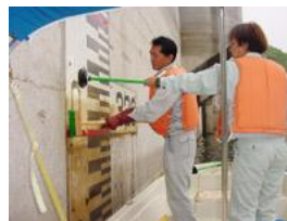
量水板の清掃状況
