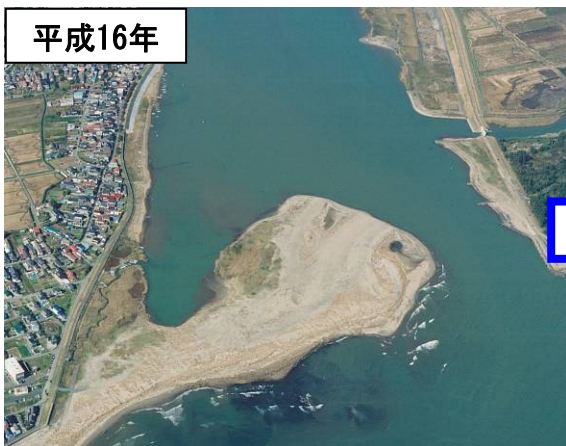
斜め写真による河道状況の把握（河口部砂州形状・樹木繁茂状況の変化の様子）
