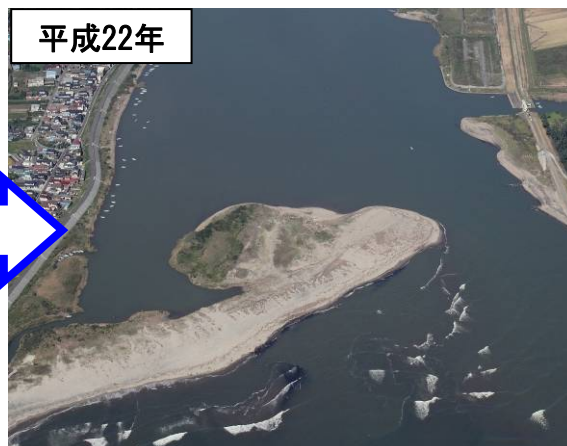
斜め写真による河道状況の把握（河口部砂州形状・樹木繁茂状況の変化の様子）
