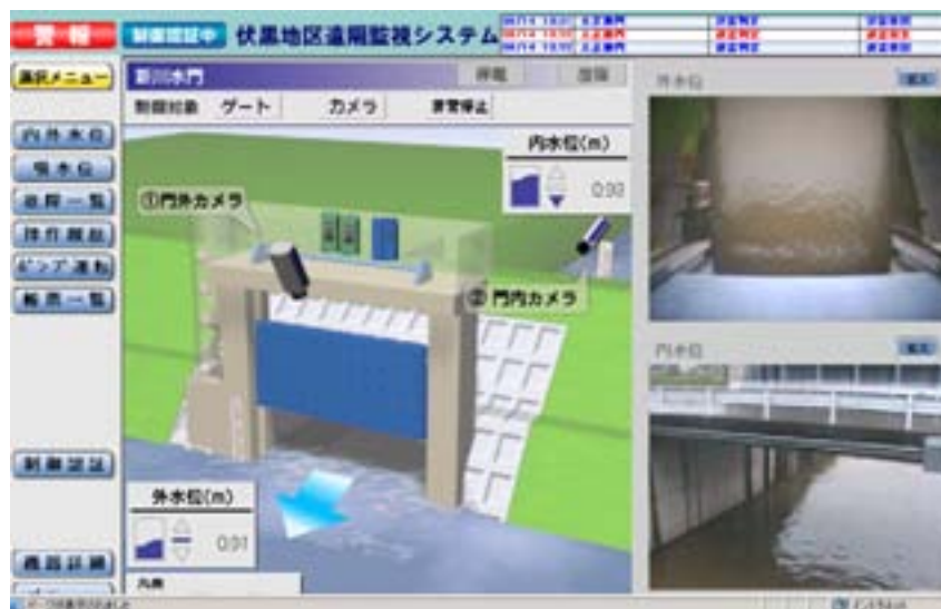
図 5-3 1 河川管理施設の遠隔監視システム
