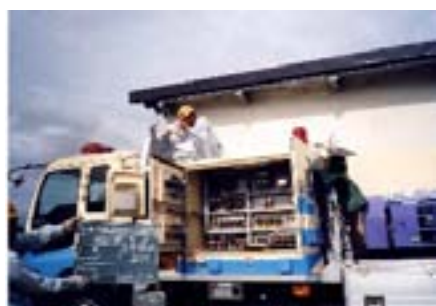
排水ポンプ車点検の様子
