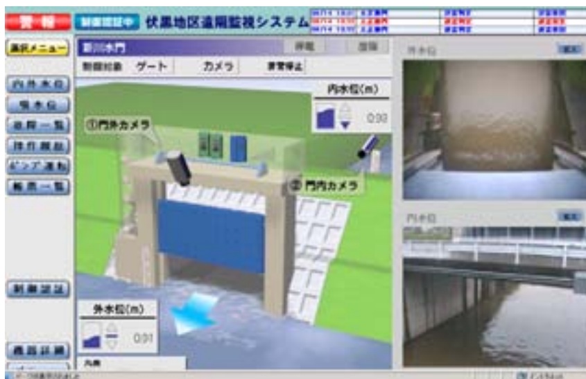
図5-31 河川管理施設の遠隔監視システム
