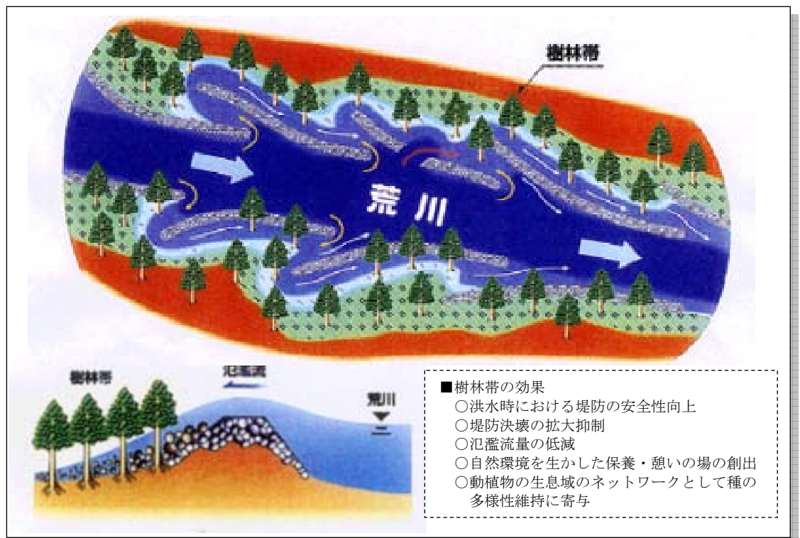
図 5 - 2 7 樹林帯の概要 (支川荒川)
